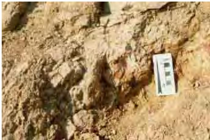
**Foto 61** - Detalhe do plano de falha inversa (104/50°), marcado por estrias (79/47°).(ponto08,rodoviaPiracicaba-SãoPedro).
